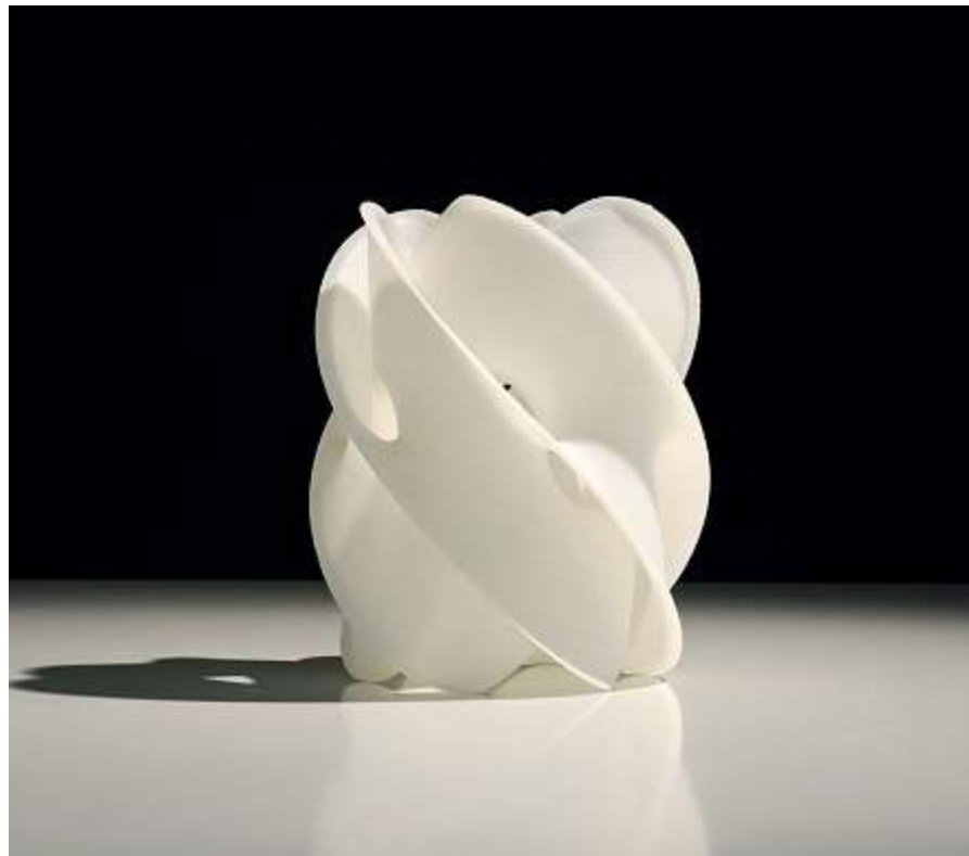
Freiform-Modell aus ABS-Kunststoff, erzeugt mit dem 3D-Drucker
