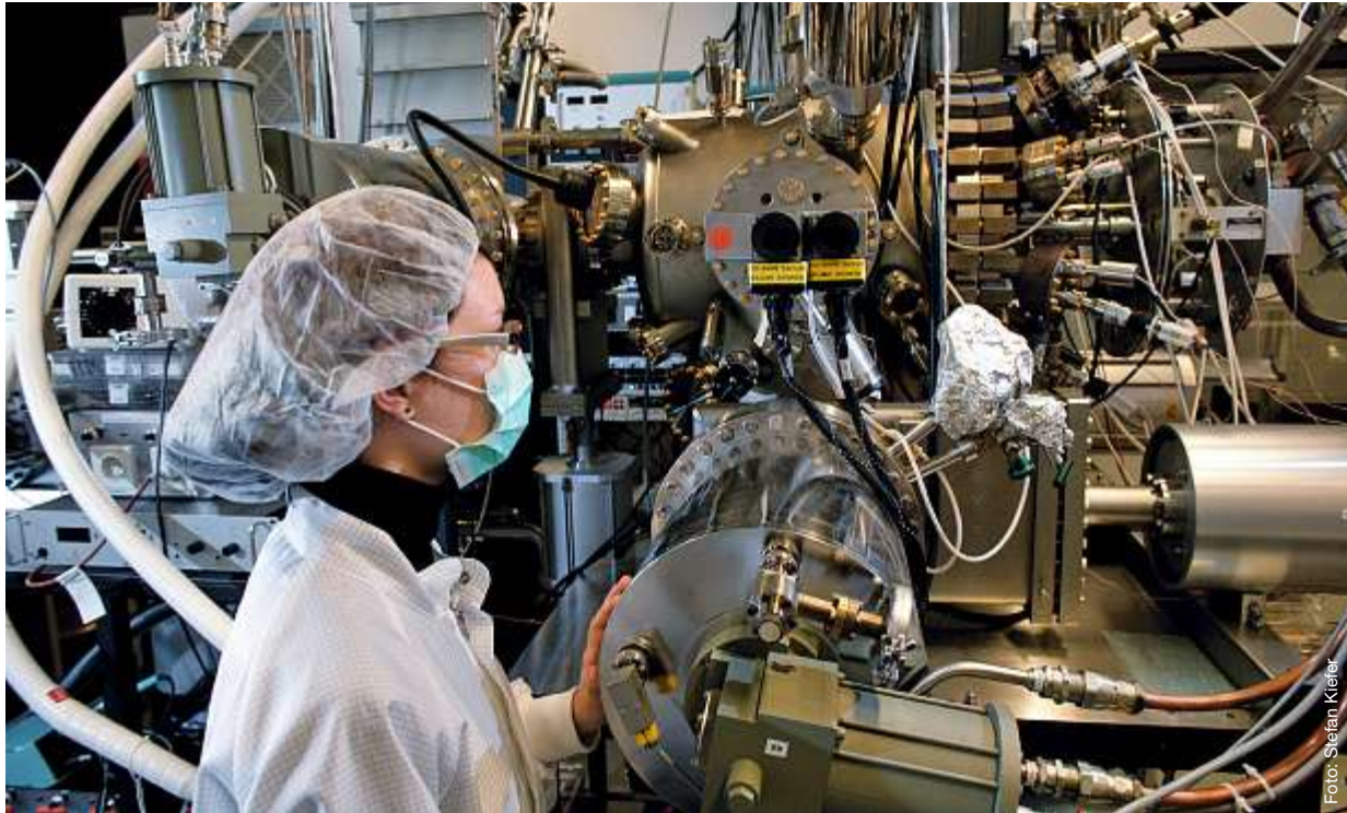
Eine Physikstudentin kontrolliert in einem Labor des WSI eine Halbleiter-Nanostruktur-Wachstumsanlage. Wegen ihrer außergewöhnlichen Reinheit bei der Produktion von Halbleiter-Nanostrukturen ist diese Anlage auf der Welt einzigartig.
