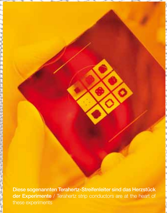
Im Reinraum des Instituts fertigen Mitglieder des Teams die filigranen Strukturen selbst an, die sie dann im Experiment untersuchen / Team members first create the delicate structures themselves in the institute's clean room before putting them to the test in various experiments
