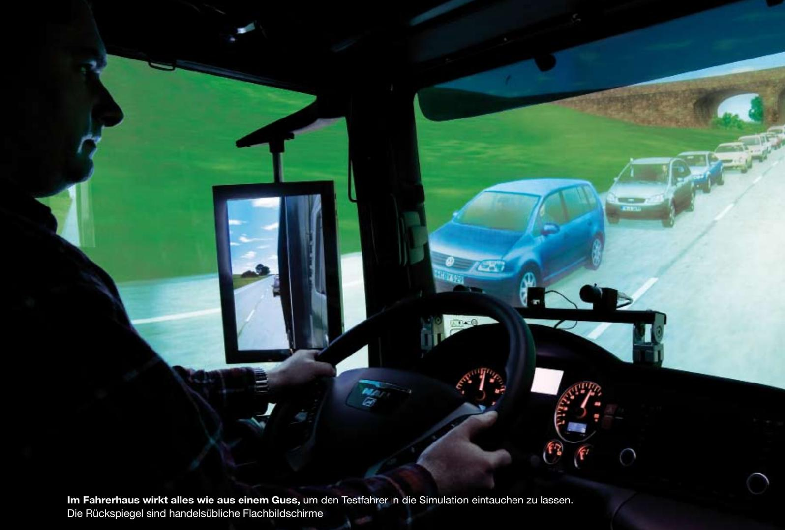
**Im Fahrerhaus wirkt alles wie aus einem Guss**, um den Testfahrer in die Simulation eintauchen zu lassen. Die Rückspiegel sind handelsübliche Flachbildschirme
