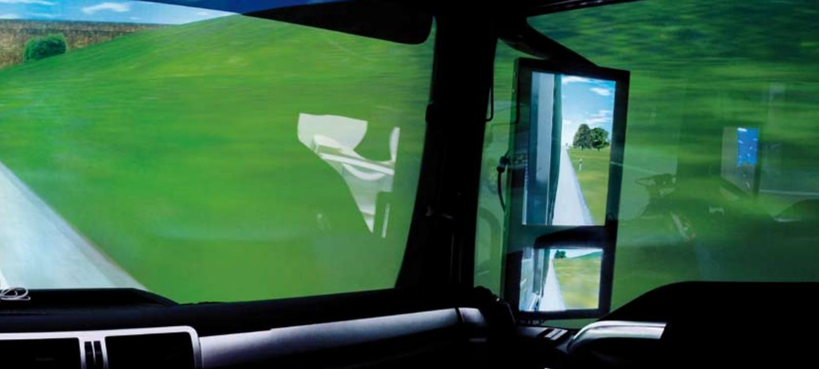
Ganz rechts noch einmal gut zu sehen: Der FTM-Fahrsimulator nutzt normale LCD-Flachbildschirme für die Rückspiegel des Digi-Trucks, so wie sie jeder Computerbenutzer eines modernen Gerätes kennt
